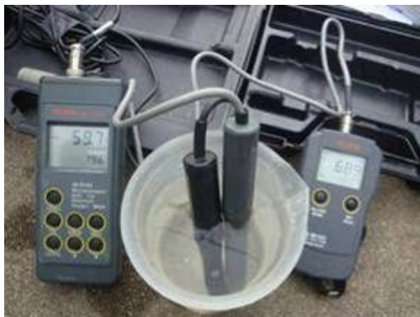
Fotografia 7: Medição do pH, Temperatura, Condutividade e Oxigénio Dissolvido com recurso a sondas portáteis
